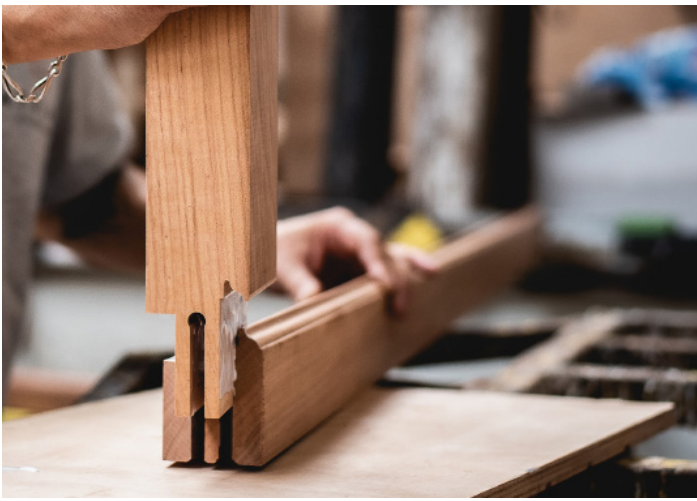
Assemblage des ouvrants par double enfourchement
