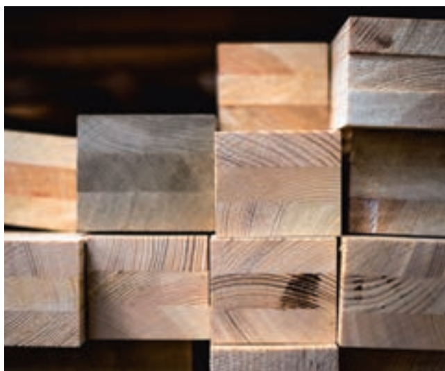
Utilisation de carrelés en lamellé-collé 3 plis pour une meilleure stabilité
