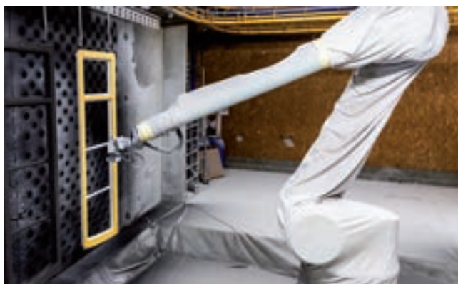
La couche de finition est appliquée par le robot pour un résultat sans coulure. Ici réalisation d'une bicoloration.
