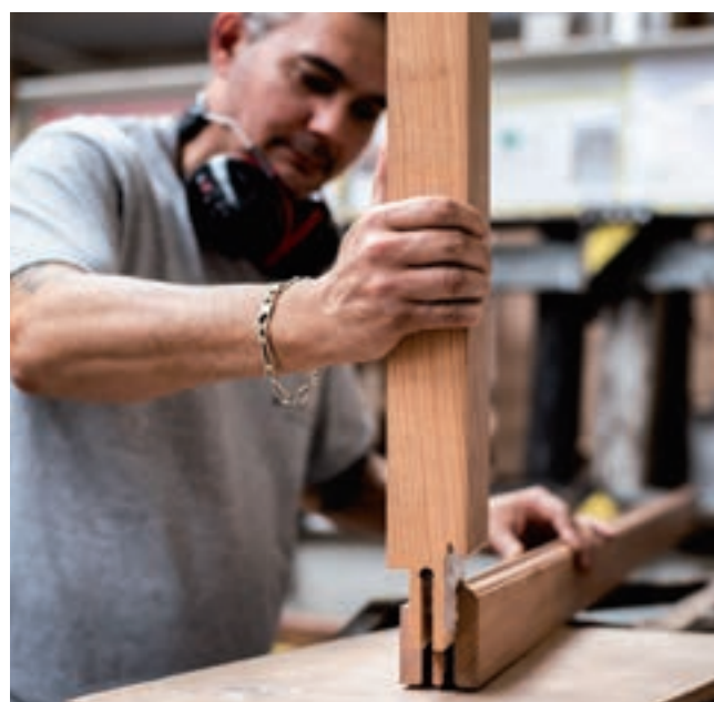
Assemblage traditionnel des ouvrants en double enfourchement
